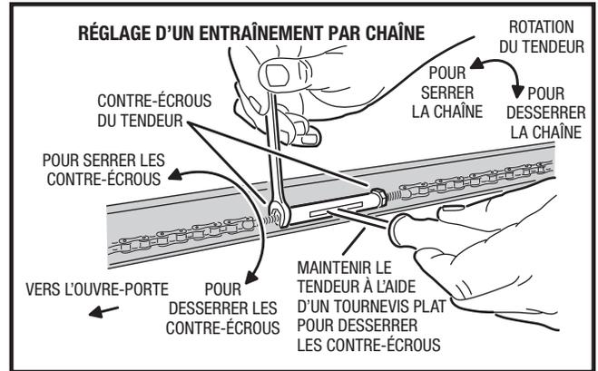
**NOTE :** Un des écrous du tendeur se tourne dans le sens inverse à celui des aiguilles d'une montre (direction opposée à la normale).
