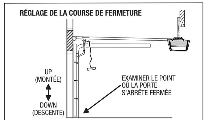
**NOTE :** Si l'ouvre-porte est réinitialisé, les deux points (ouverture et fermeture) doivent impérativement être réglés à nouveau, et le réglage de la force de la porte doit aussi obligatoirement être refait pour fonctionner correctement.
