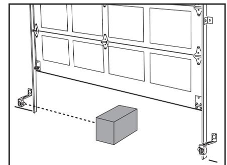
**IMPORTANT :** Si la porte du garage se ferme quand le faisceau photo-électrique de sécurité est obstrué, faire appel à un technicien spécialisé en portes de garages.
