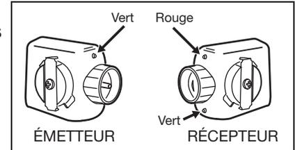
Par mesure de sécurité, l'ouvre-porte ne tient compte des signaux d'aucune télécommande quand la porte est ouverte et que le faisceau photo-électrique est obstrué ou mal aligné. Dans ce cas, on peut quand même fermer la porte par un appui maintenu sur le bouton fléché de montée/descente du boîtier de commande mural, en s'assurant que la porte est bien visible.
